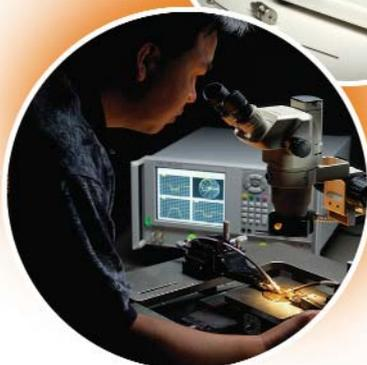
Зондовые измерения компонентов на пластинах
