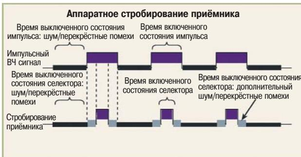
Рисунок 4 - Метод аппаратного стробирования приёмника
