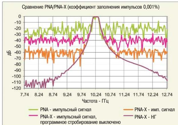
Рисунок 6 - Сравнение PNA-X и PNA при измерении параметров цепей в импульсном режиме
