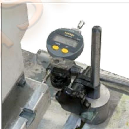
Контроль вертикального перемещения элементов станков, машин и пр.
